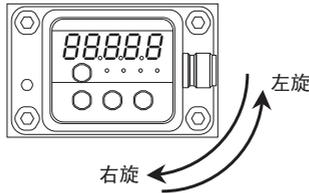
旋转超过上述角度的场合，可能造成产品内部的连接头脱落而不能动作。
