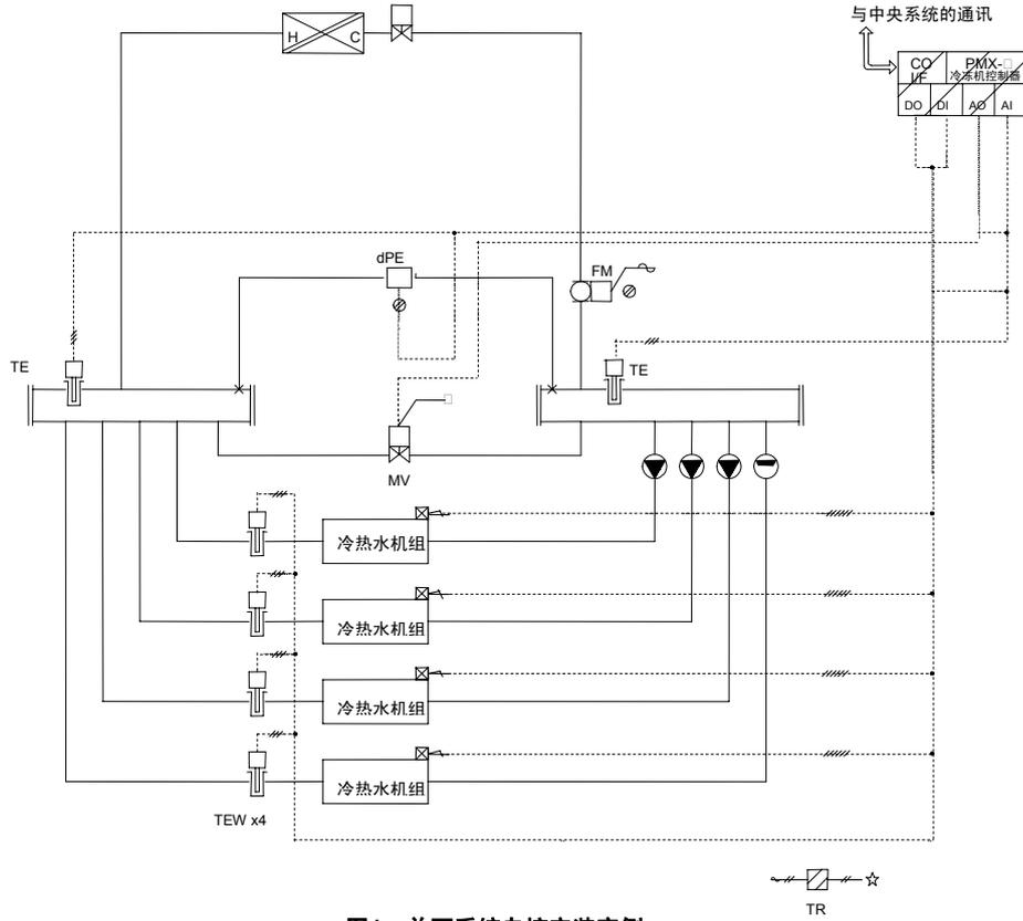
图1 单泵系统自控安装实例
