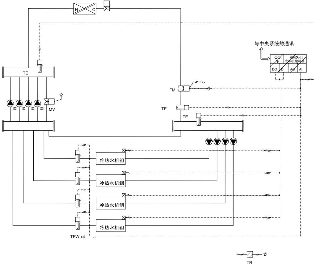
图2 双泵系统自控安装实例
