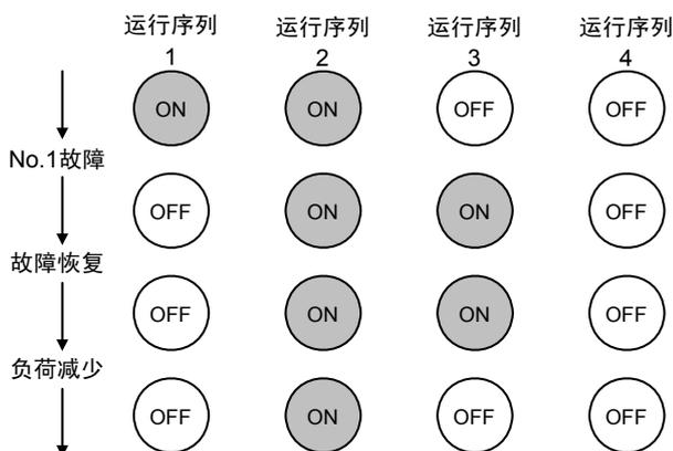
在这种情况下，启动机组和停止机组可能混在一起，如果执行一次启动停止，可能由于压力的不正常增长以及机组启动延迟导致容量降低，因此应同时处理ON/OFF操作。同时处理ON/OFF操作可选择以下两种方法。
