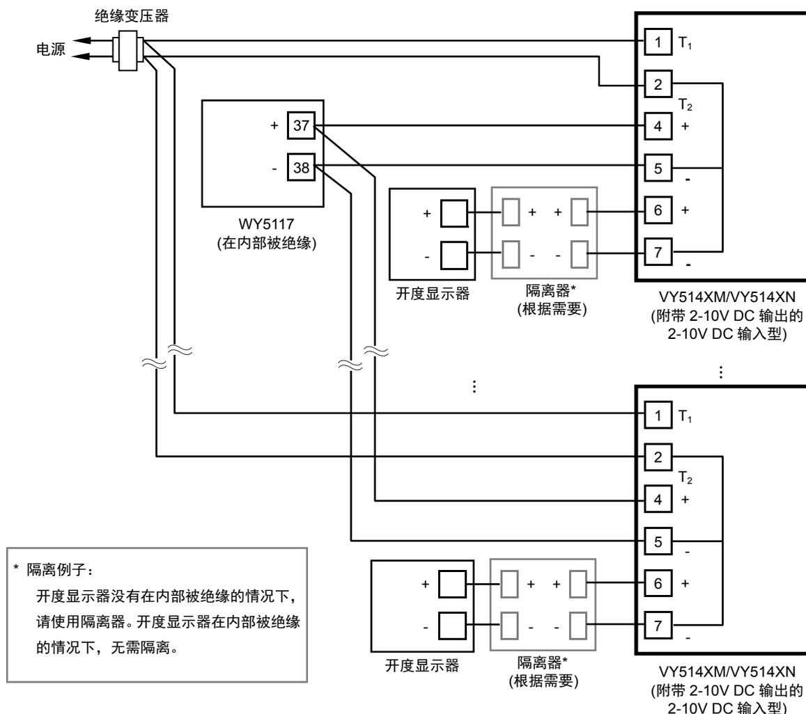
图 20 配线例子(3): VY514XM / VY514XN 和 WY5117 的连接
