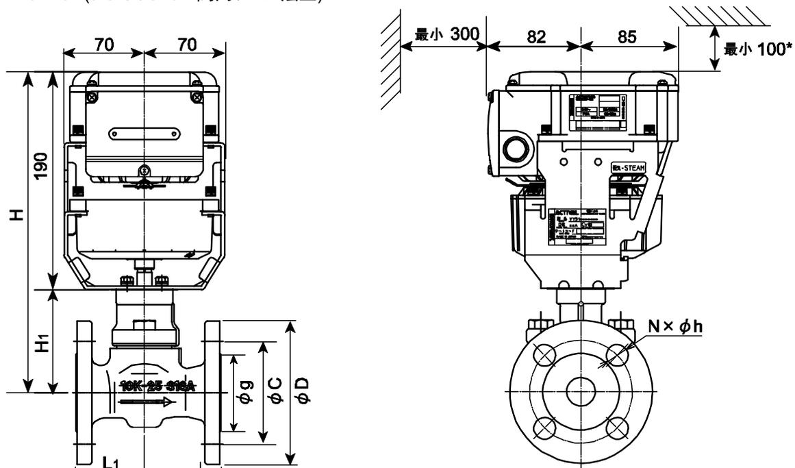
\* 在开启顶盖进行操作(辅助开关的设定等)的情况下, 请保留不少于 300mm 的间距。
