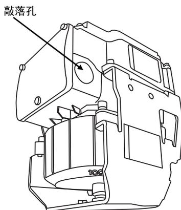
图6 敲落孔
