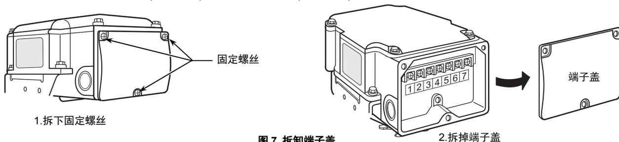
图7 拆卸端子盖
