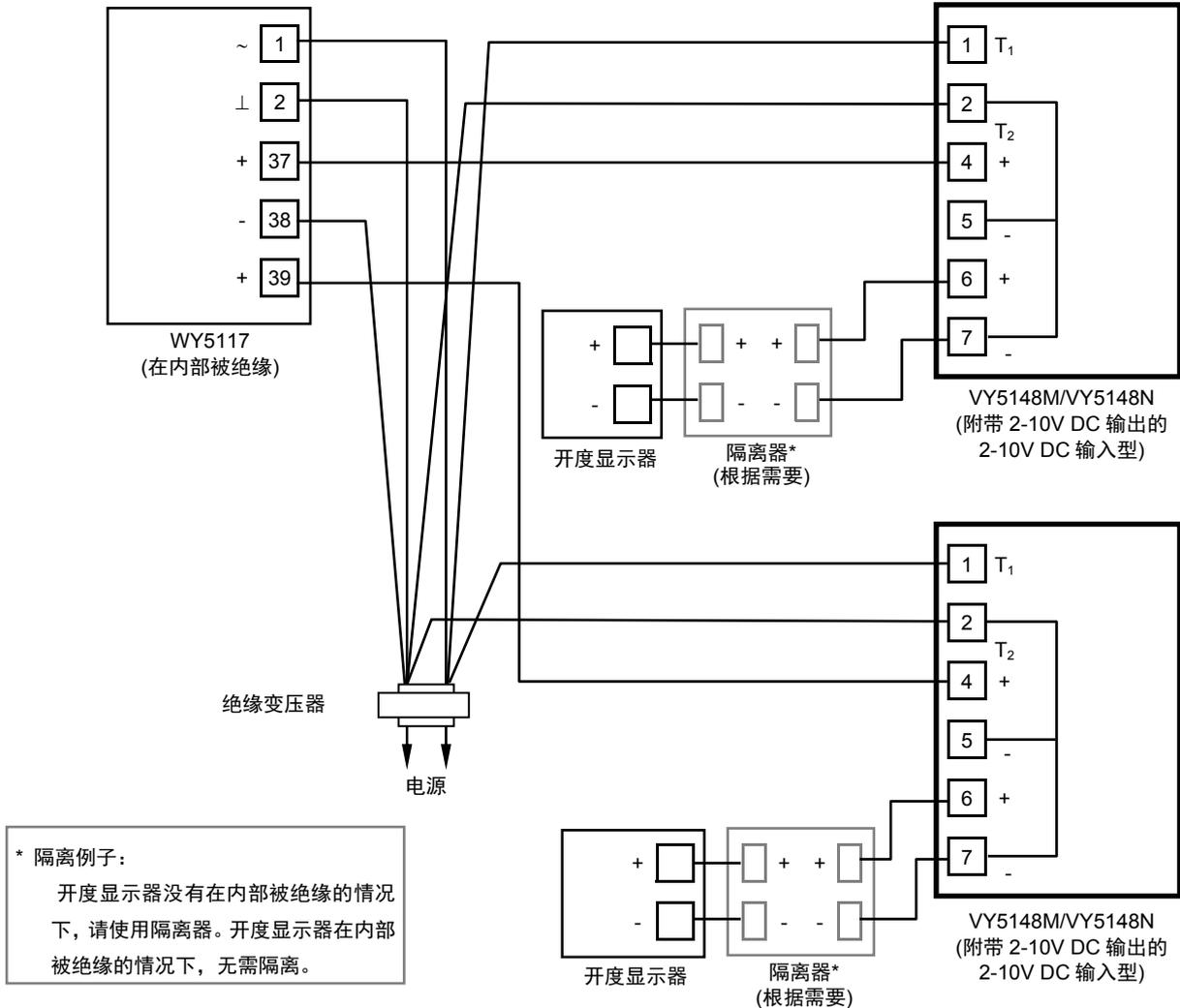
图 21 配线例子(4): VY514XM / VY514XN 和 WY5117 的连接
