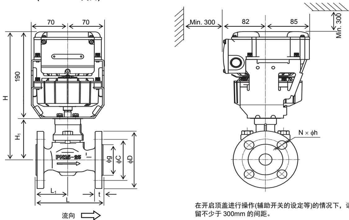
在开启顶盖进行操作(辅助开关的设定等)的情况下,请保留不少于 300mm 的间距。
