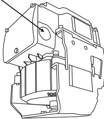
图 5 敲落孔
