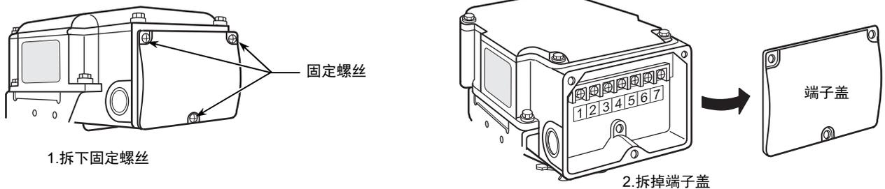
图 6 拆卸端子盖
