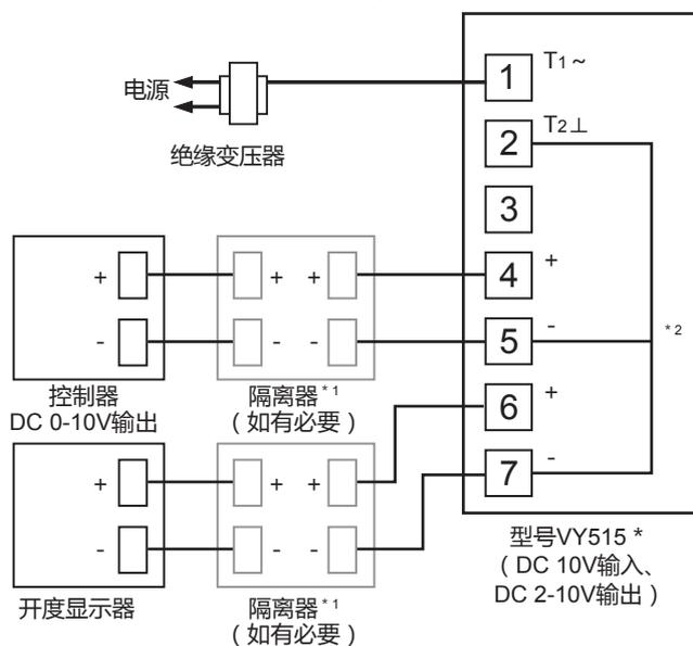
\*1 请连接内部已绝缘的设备(开度显示器等), 另外, 设备(开度显示器等)的端子不明确或内部未绝缘的场合, 请将本产品与设备进行隔离。
