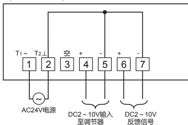
(注) 端子 2 (电源)、端子 5 (DC2 ~ 10V 输入)、端子 7 (DC2 ~ 10V 反馈信号) 已在内部连接。
