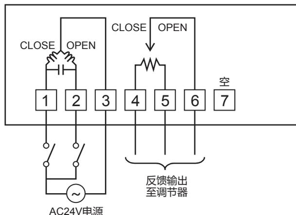
(注) 推荐将端子 4 - 6 间的电压值作为反馈信号读取的控制器。
