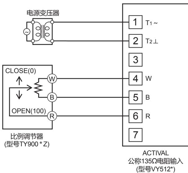
图 16 与 Neostat 的连接例
