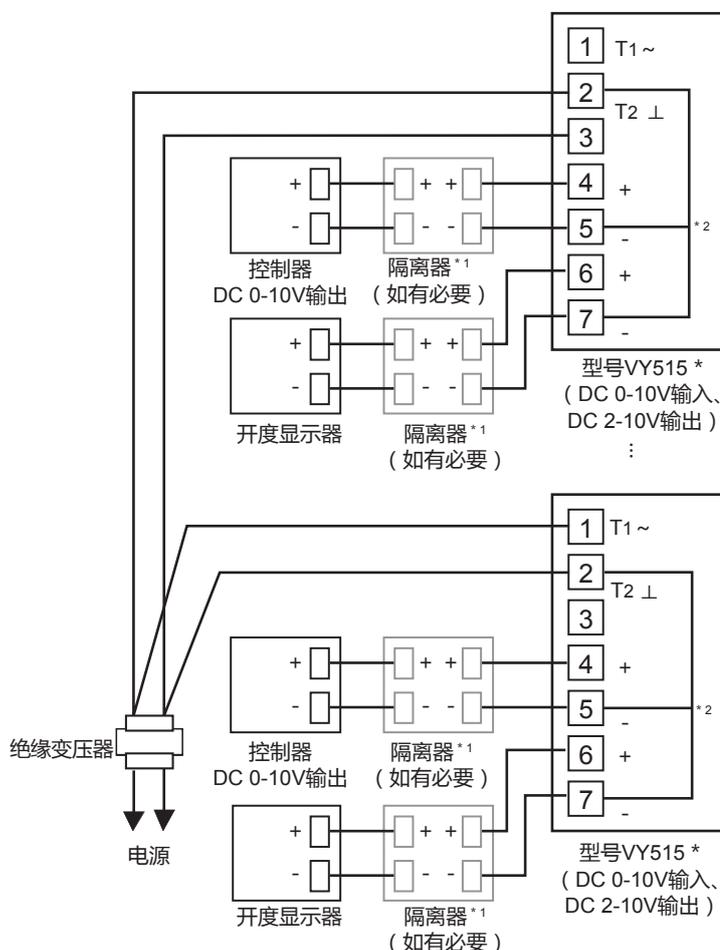
\*1 请连接内部已绝缘的设备（控制器、开度显示器等），另外，设备（控制器、开度显示器等）的端子不明确或内部未绝缘的场合，请将本产品与设备进行隔离。
