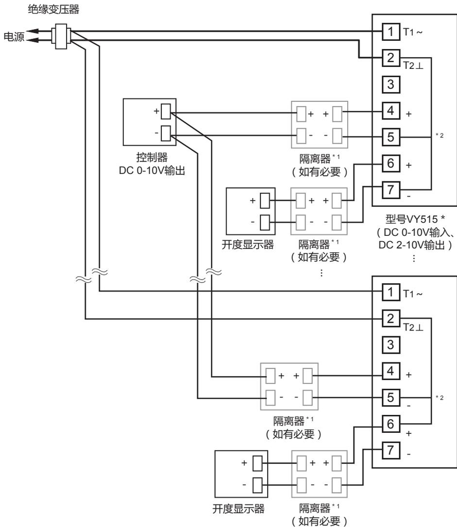
\*1 请连接内部已绝缘的设备（控制器、开度显示器等），另外，设备（控制器、开度显示器等）的端子不明确或内部未绝缘的场合，请将本产品与设备进行隔离。
