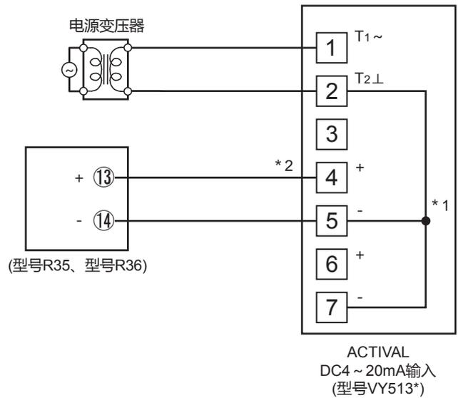
\*1 端子 2 (电源)、端子 5 (DC4 ~ 20mA 输入)、端子 7 (DC2 ~ 10V 反馈信号) 已在内部连接。
