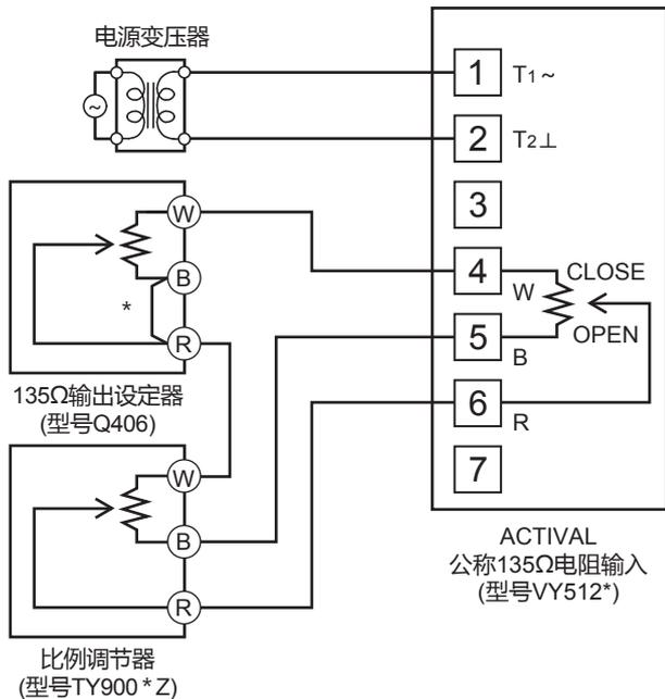
除比例调节器外, 还可通过追加 135Ω 输出的设定器, 可在 0 ~ 约 50% 的范围内设定执行器的最小开度。
