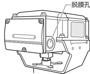
**重要!!** ●请勿将打开脱膜孔时产生的金属片残留在执行器内部。
