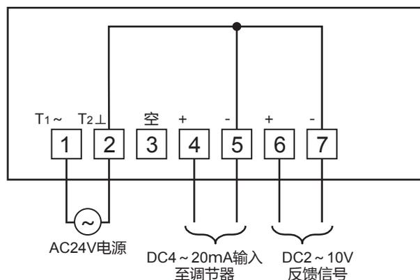
(注) 端子 2 (电源)、端子 5 (DC4 ~ 20mA 输入)、端子 7 (DC2 ~ 10V 反馈信号) 已在内部连接。
