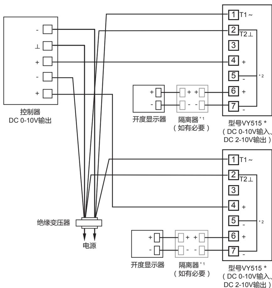
\*1 请连接内部已绝缘的设备(开度显示器等), 另外, 设备(开度显示器等)的端子不明确或内部未绝缘的场合, 请将本产品与设备进行隔离。
