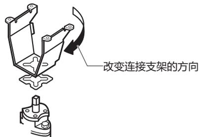
(6) 在连接支架和阀之间按原样插入步骤(3)取下的隔热型垫片, 并用螺丝将连接支架安装到阀上。
