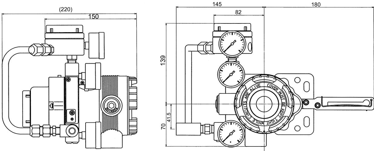
带型号 RA1B 减压阀的双作用机构
