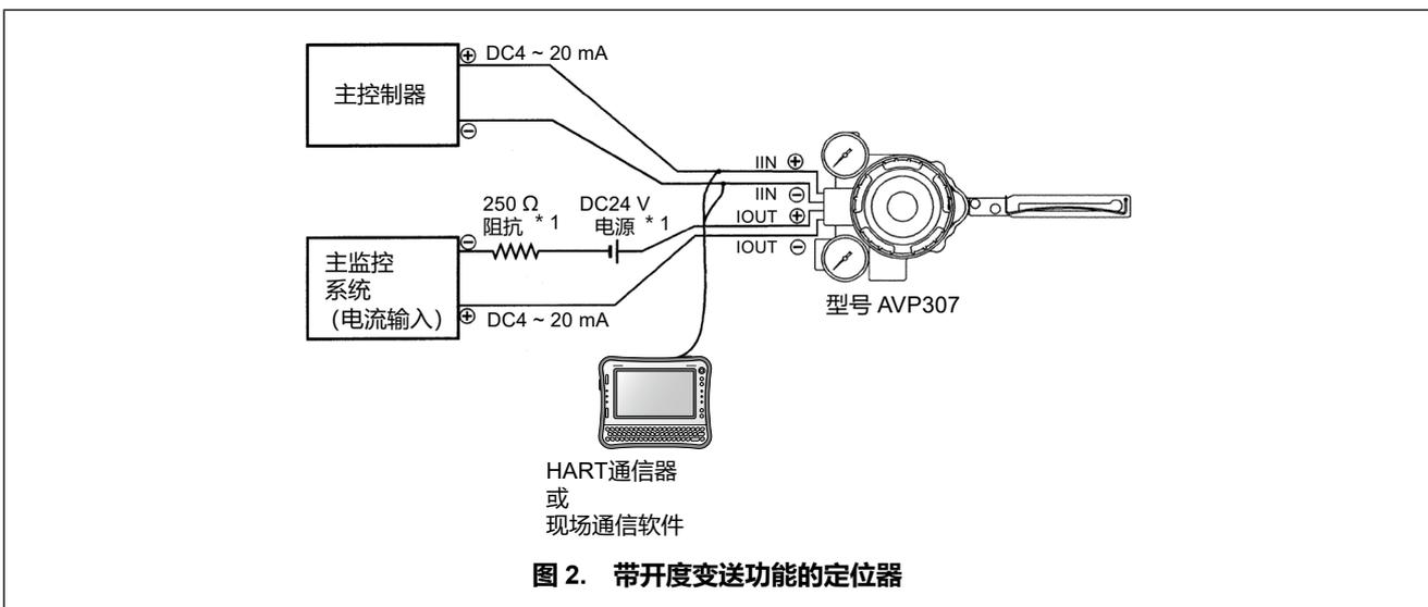
图 2. 带开度变送功能的定位器
