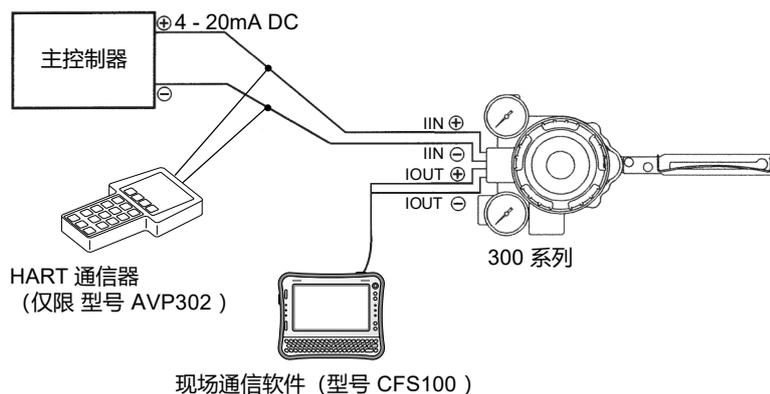
图 1. 通用电-气动定位器 (型号 AVP300/302 )
