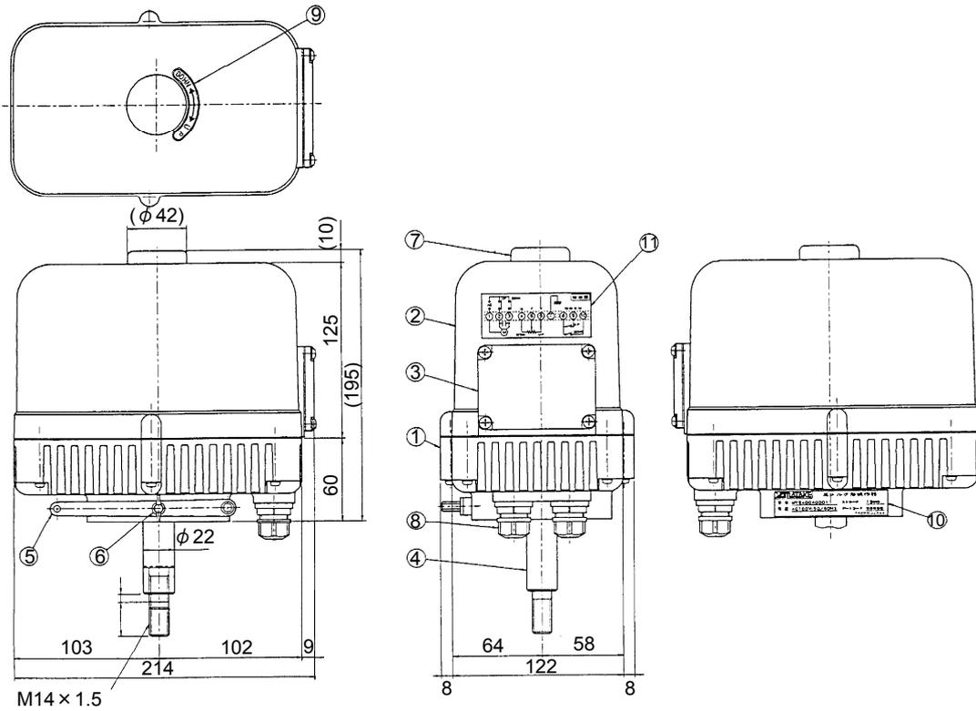
图 1. 外形尺寸、各部分的名称：执行器(mm)
