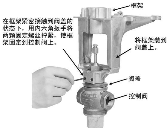
图2 将框架安装到阀盖上
